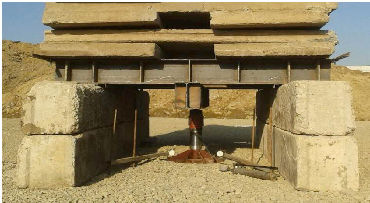
Рис.2.30. Общий вид установки штамповых испытаний
