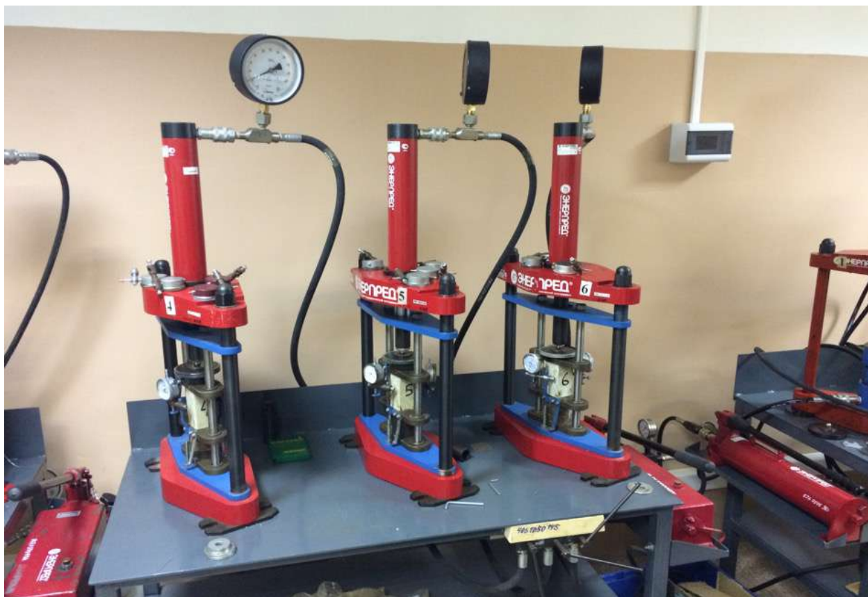
Рис.2.24. Общий вид установки по определению характеристик ползучести грунтобетона
