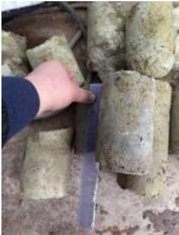
Рис.2.10. Контрольные работы: замер размеров грунтобетонного элемента и отбуренных грунтобетонные керны
