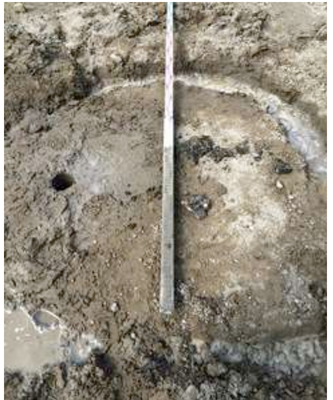
Рис.2.10. Контрольные работы: замер размеров грунтобетонного элемента и отбуренных грунтобетонные керны
