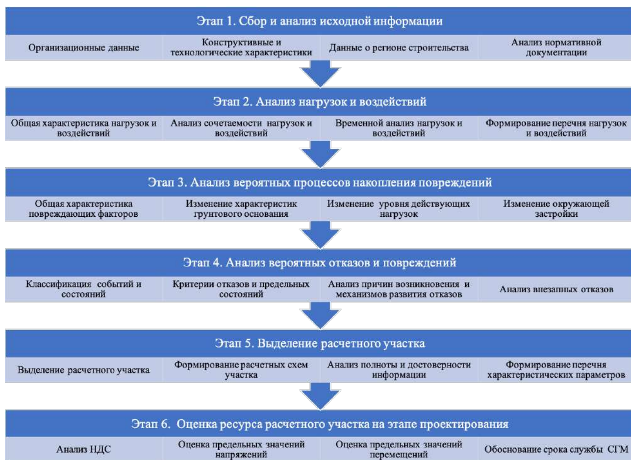
Рис.5.1. Алгоритм оценки надежности сложной геотехнической системы
