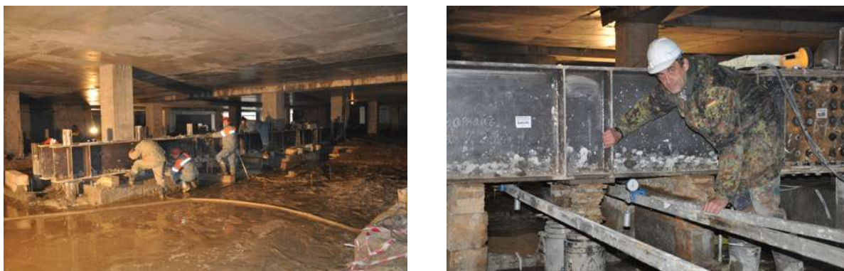
Рис.2.21. Проведение испытаний статической вдавливающей нагрузкой
