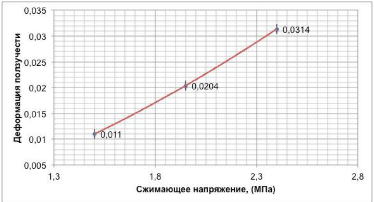
Рис. 2.28. Диаграмма и аппроксимирующая кривая функции напряжений F(\sigma)
