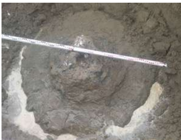
Рис.6.3 Грунтобетонный армирующий элемент
