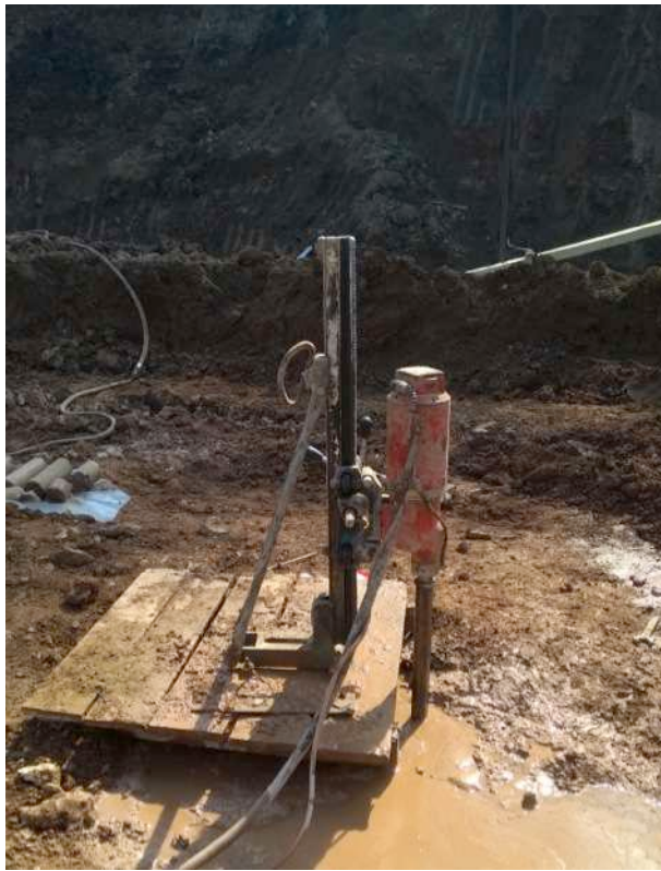
Рис. 2.9. Процесс отбора и общий вид и выбуренных кернов
