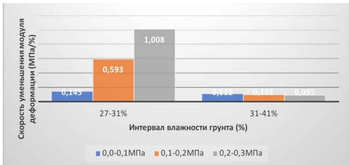
Рис. 2.43. График зависимости скорости уменьшения модуля деформации от влажности
