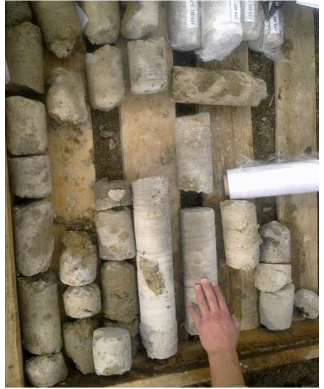
Рис. 2.9. Процесс отбора и общий вид и выбуренных кернов
