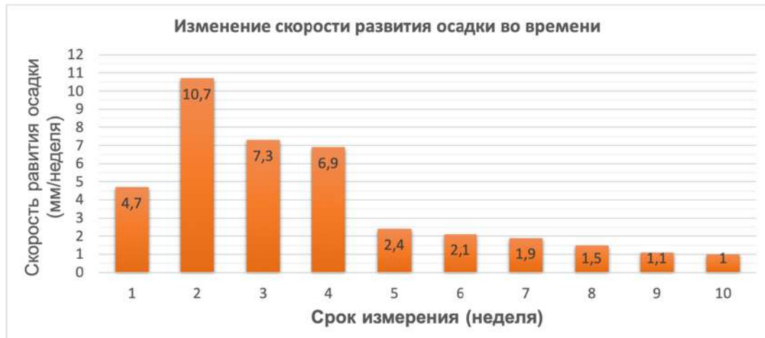
Рис.2.48. Диаграмма изменения скорости развития осадок (мм/неделю) в процессе устройства основания «структурный геомассив»
