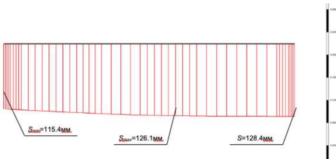
Рис.4.33. Эпюра вертикальных перемещений внутреннего пространства (сечение 3-3)
