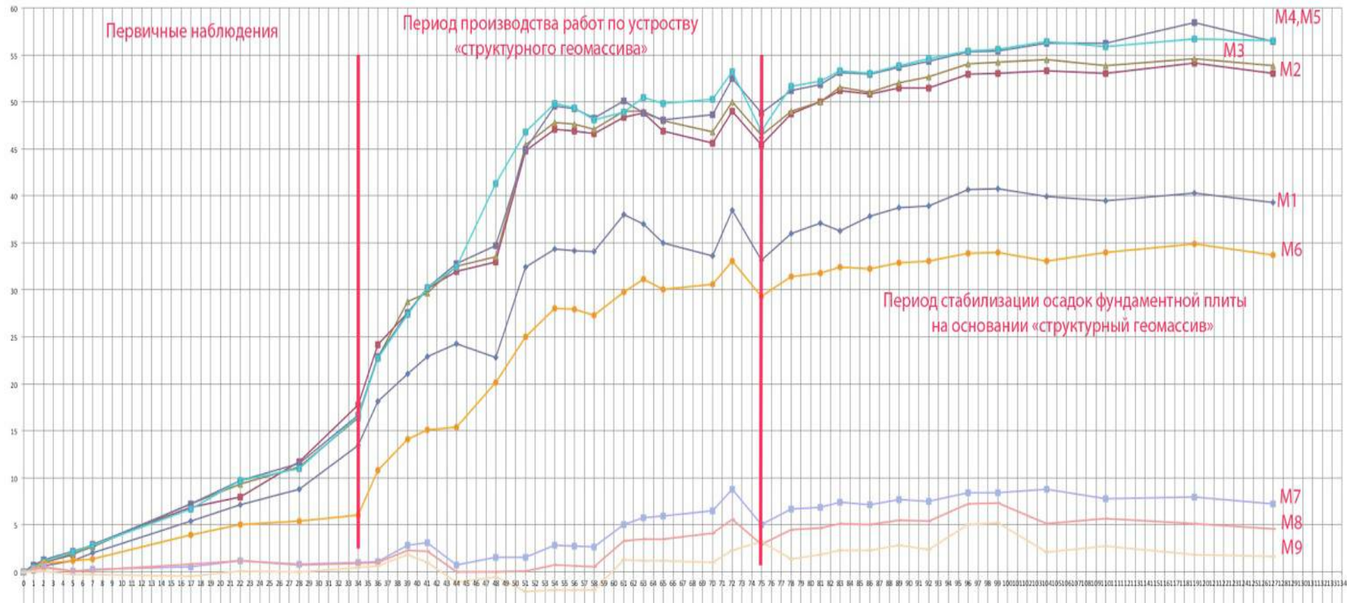
Рис.5.14. График результатов геодезического мониторинга при наблюдательном методе проектирования и устройства структурного геотехнического массива в основании существующей фундаментной плиты
