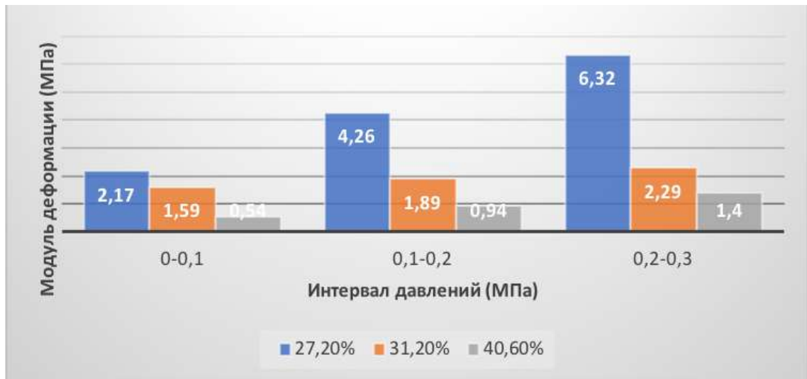
Рис.2.44. График зависимости модуля деформации от действующего давления
